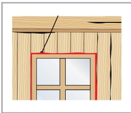
Banda precompressa a base di Poliuretano espandibile e adattabile ad ogni tipo di fessura (fine a 12mm) presente tra gli elementi costruttivi. La banda per fughe è composta da una banda acrilica per fissaggio. Garantisce una buona impermeabilità alla acqua e vento.
