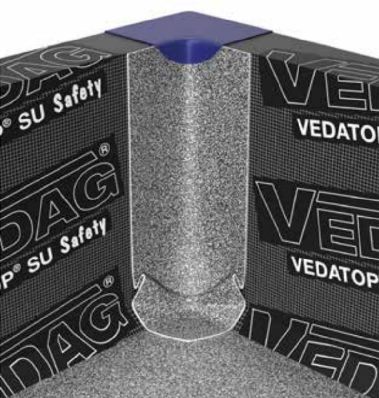
Zuschnitt = Breite der Attikakrone + Attikahöhe + Schenkelmaß des Keils + Überlappung auf die Abdichtungsbahn der Fläche
