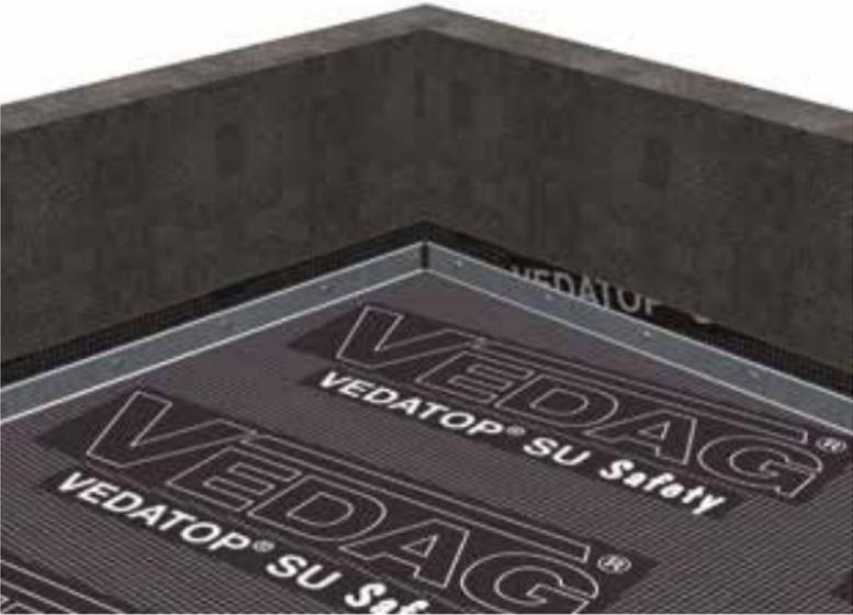
Keil, z. B. aus Dämmstoff, im Eckbereich auf Gehrung schneiden und fluchtgerecht am Übergang der ersten Abdichtungslage zum aufgehenden Bauteil einbauen.
