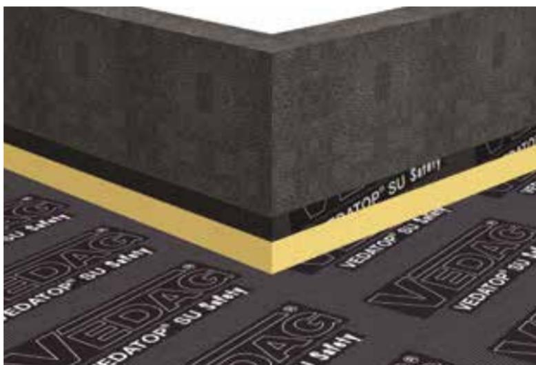
Zuschnitt = aufgehendes Maß (mindestens 10 cm) + Schenkelmaß des Keils + Überlappung auf die Abdichtungsbahn in der Fläche
