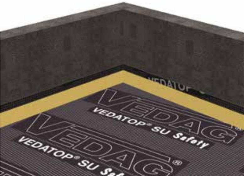
Zuschnitt = aufgehendes Maß (mindestens 10 cm) + Schenkelmaß des Keils + Überlappung auf die Abdichtungsbahn in der Fläche
