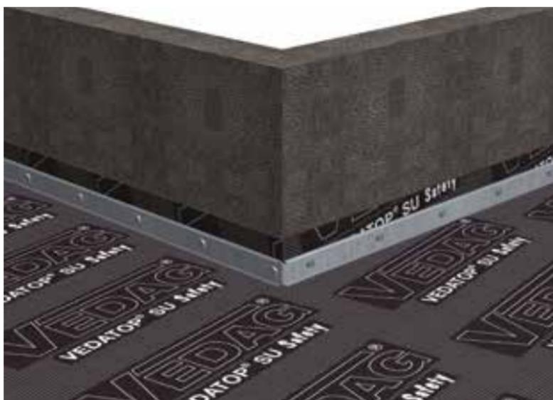
Keil, z. B. aus Dämmstoff, im Eckbereich auf Gehrung schneiden und fluchtgerecht am Übergang der erste Abdichtungslage zum aufgehenden Bauteil einbauen.
