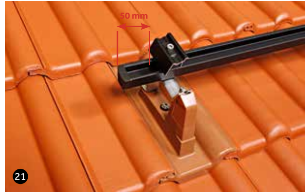
21 Universal-End-Modulklemme mindestens 50 mm ab Modulrahmenkante montieren.
