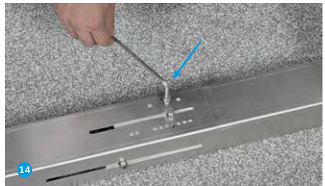
Den Abstand mit den in der Schablone enthaltenen Inbusschrauben fixieren. Diese sind fest anzuziehen.
