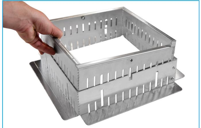
Kontrollschacht mittig über Entwässerungseinrichtung positionieren. Mit den aufliegenden Schenkeln auf dem Drainage- und Wasserspeicherelement oder der wasserspeichernden Steinwollefasermatte einbauen um einen möglichst ungehinderten Wasserabfluss zu ermöglichen.
