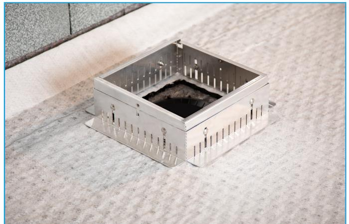
Sind die Entwässerungspunkte an Aufkantungungen eingebaut, können bei Bedarf die Auflageschenkel des Kontrollschachts abgeschnitten werden um den Schacht näher an die Aufkantung zu positionieren.
