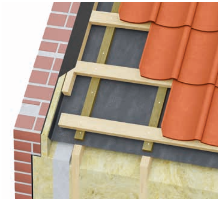
GAVL UDEN UDHÆNG, VENTILERET
