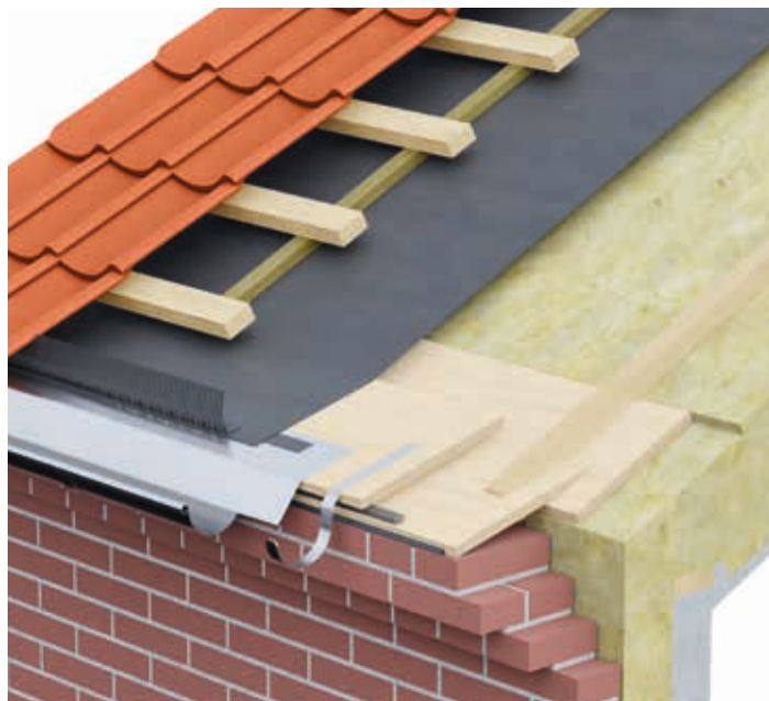
TAGFOD UDEN UDHÆNG, VENTILERET
