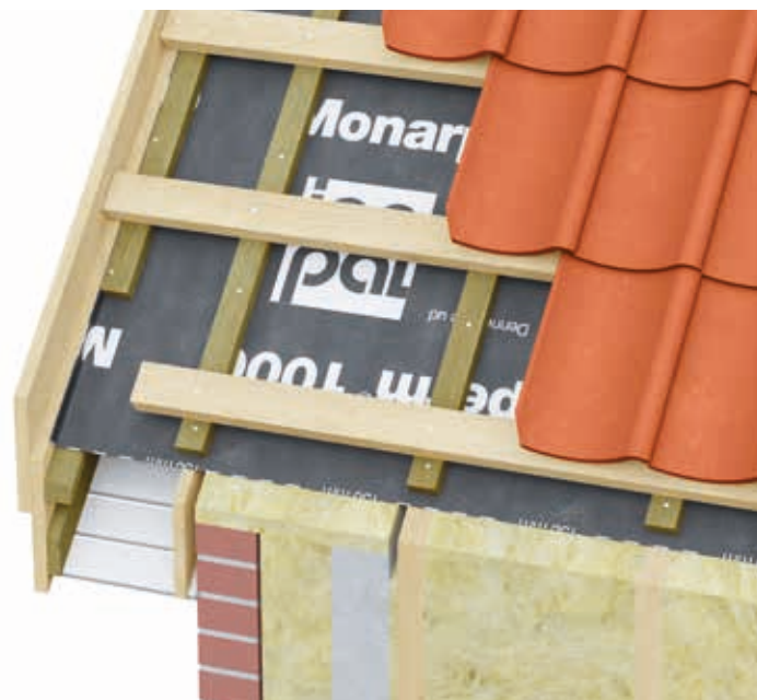
GAVL MED UDHÆNG, UVENTILERET
