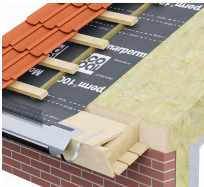
TAGFOD MED UDHÆNG, UVENTILERET
