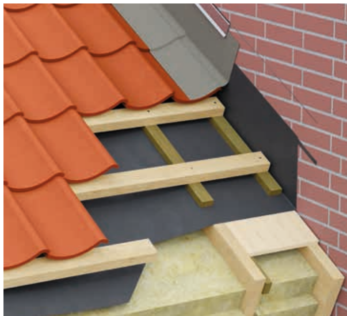
INDDÆKNING MOD MUR, VENTILERET
