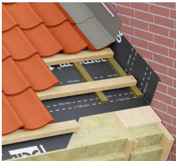
INDDÆKNING MOD MUR, UVENTILERET
