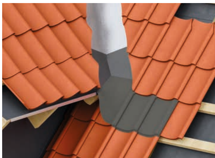
En vigtig detalje ved kvistsens skotrende er hvorledes det formbare inddækningsstykke (Wakaflex) føres ud mellem tagstenene.
