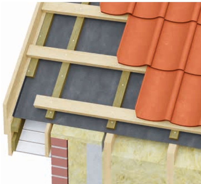
GAVL MED UDHÆNG, VENTILERET
