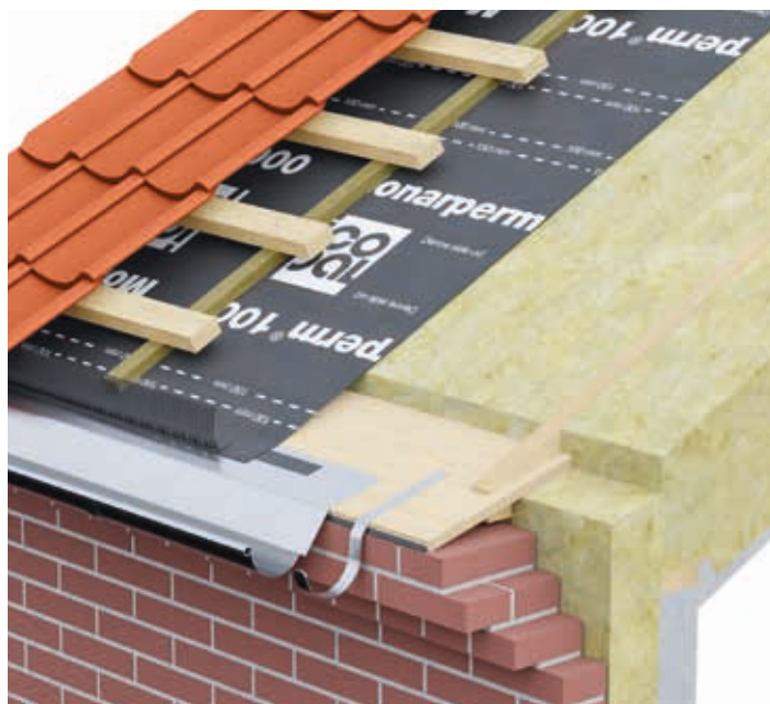
TAGFOD UDEN UDHÆNG, UVENTILERET
