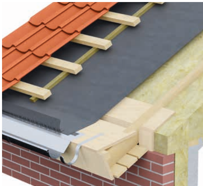
TAGFOD MED UDHÆNG, VENTILERET
