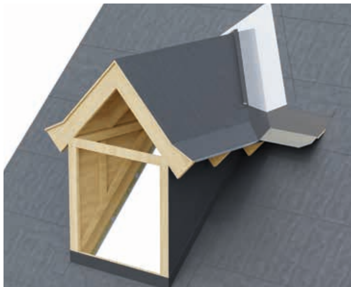
I skotrenden monteres et inddækningsprofil af aluminium. På kvistsiden etableres en siderende af trykimprægnerede afstandslistes, som inddækkes med tagpap over alu-profilen.
