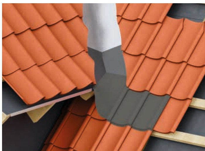
En vigtig detalje ved kvistens skotrende er hvorledes det formbare inddækningsstykke (Wakaflex) føres ud mellem tagstenene.
