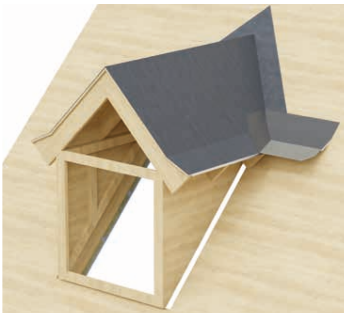
På undertaget i forlængelse af den løftede tagfod på kvisten monteres et tilpasset krydsfinerestykke på langs af tagfladen.
