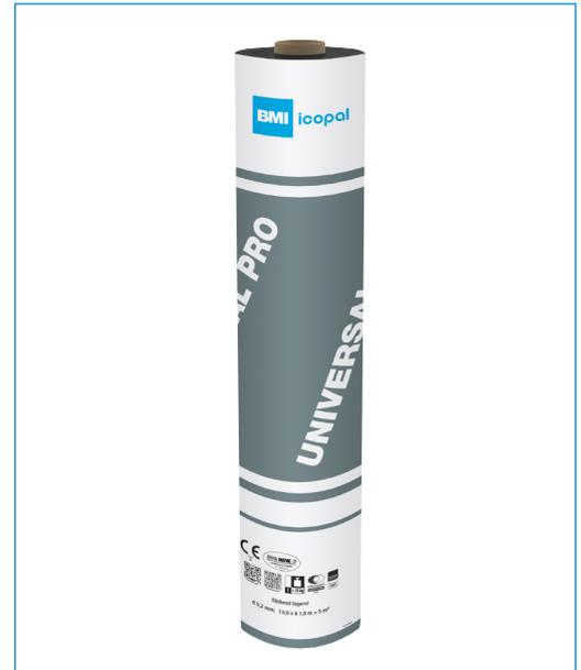
Universal Pro ist einsetzbar auf gefällelosen Untergründen und bis 20 Grad Dachneigung in Neubau und Sanierung. Ihre Verwendung erfolgt im Anwendungsbereich der DIN 18531 in den Anwendungsklassen K1 und K2 und der Fachregel für Abdichtungen – Flachdachrichtlinie.
