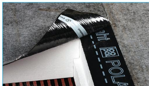
\* Doppelte BMI Icopal Sicherheitsnaht, d. h. Nahtbereich oben und unten aus gleichem Spezialbitumen, Nahtfolie oberseitig mit Cut-Lines und einem 2 cm breiten SK-Streifen plus 8 cm verschweißbarer Naht.
