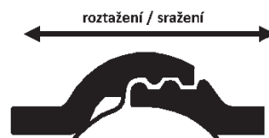
Schématické zobrazení roztaženého položení dle ČSN EN 491
