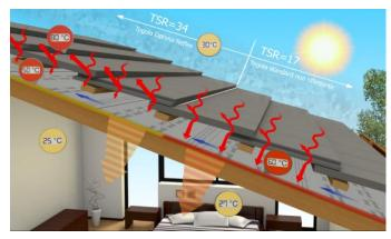
Schema rappresentativo del funzionamento della superficie Protector<sup>®</sup> Reflex rispetto ad una copertura tradizionale.
