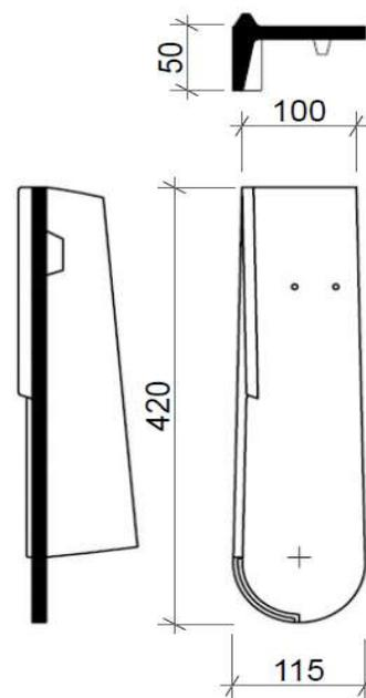
V případě, že štítová hrana není kolmá na okapní hranu, nelze krajní tašky použít a zakončení štítové hrany se pak řeší pomocí klempířských výrobků.
