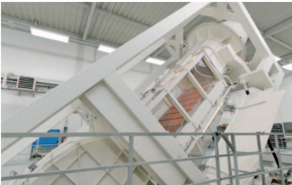
Regen- und Sturmsicherheit im Windkanal unter den härtesten Bedingungen getestet und bewiesen.
