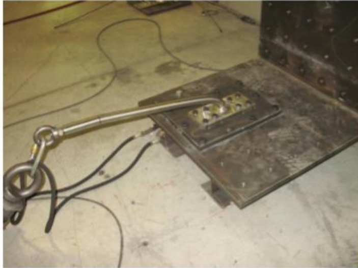
ANCORAGGIO DOPO LA PROVA IN DIREZIONE X
