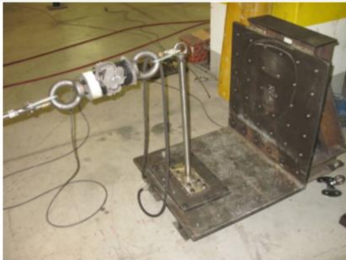
ANCORAGGIO PRIMA DELLA PROVA IN DIREZIONE Y
