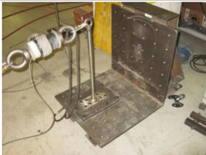
ANCORAGGIO PRIMA DELLA PROVA IN DIREZIONE X
