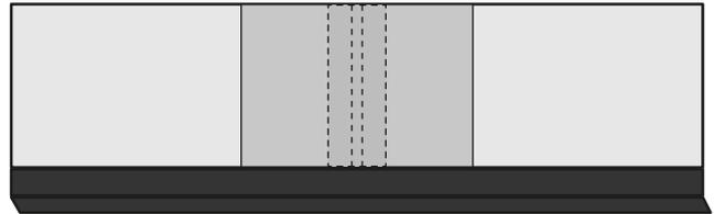
Ahora suelde una pieza de lámina de cubierta sobre la parte trasera
