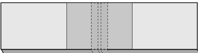
Suelde la parte trasera sobre una tira con una anchura aprox. de 100 mm de EverGuard TPO sin armadura
