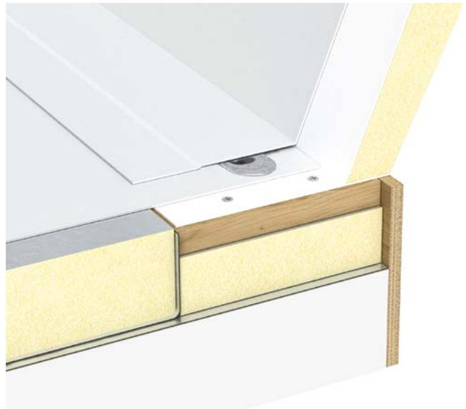
Figura 10. Acabado de la lámina con vista detallada del lucernario.
