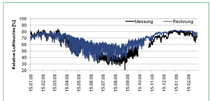
Luftfeuchte in der kritischen Ebene (zw. Dämmung und oberer OSB) bei Var. 1.1
