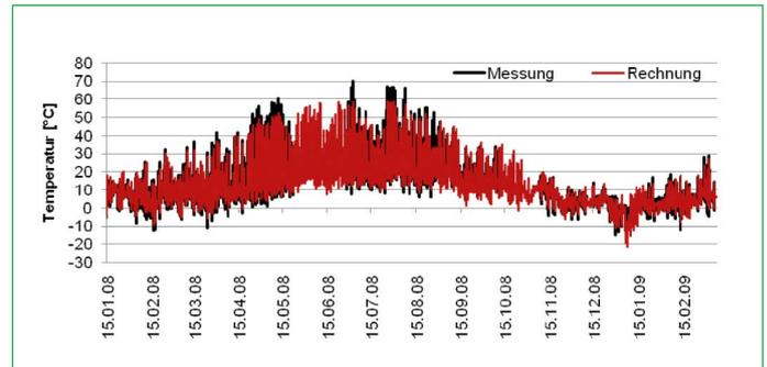
Temperatur in der kritischen Ebene (zw. Dämmung und oberer OSB) bei Var. 1.1
