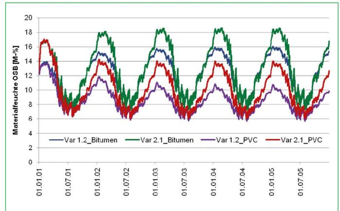
Stofffeuchte in der OSB-Platte im Vergleich für Aufbau mit Bitumen-Dachabdichtung (sd = 300 m) und Schwarzer PVC-Bahn (sd = 19 m), für Var. 1.2 und Var. 2.1
