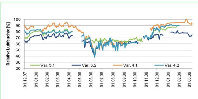
Relative Luftfeuchte in der kritischen Ebene (zw. Dämmung und Beplankung), gemessene Tagesmittel für Var. 3.1 bis 4.2
