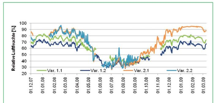
Relative Luftfeuchte in der kritischen Ebene (zw. Dämmung und Beplankung), gemessene Tagesmittel für Var. 1.1 bis 2.2
