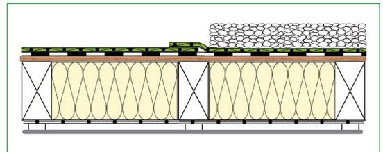
Die obere Tragschale wurde aus statischen Gründen mit einer Holzwerkstoffplatte oder Vollholz ausgebildet. Darauf brachte man das Abdichtungssystem entweder als offene Verlegung ohne Oberflächenschutz oder aber als System mit Begrünung oder Kiesauflast auf.
