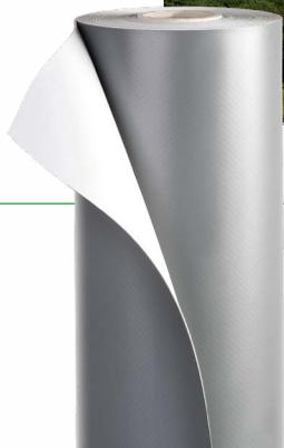
**Cosmofin GG plus ist eine hochwertige thermoplastische Kunststoffdachbahn aus monomer weichgestelltem PVC, mittig verstärkt mit einem äußerst stabilen Kombinationsträger aus Glaslege und Glasvlies.**
