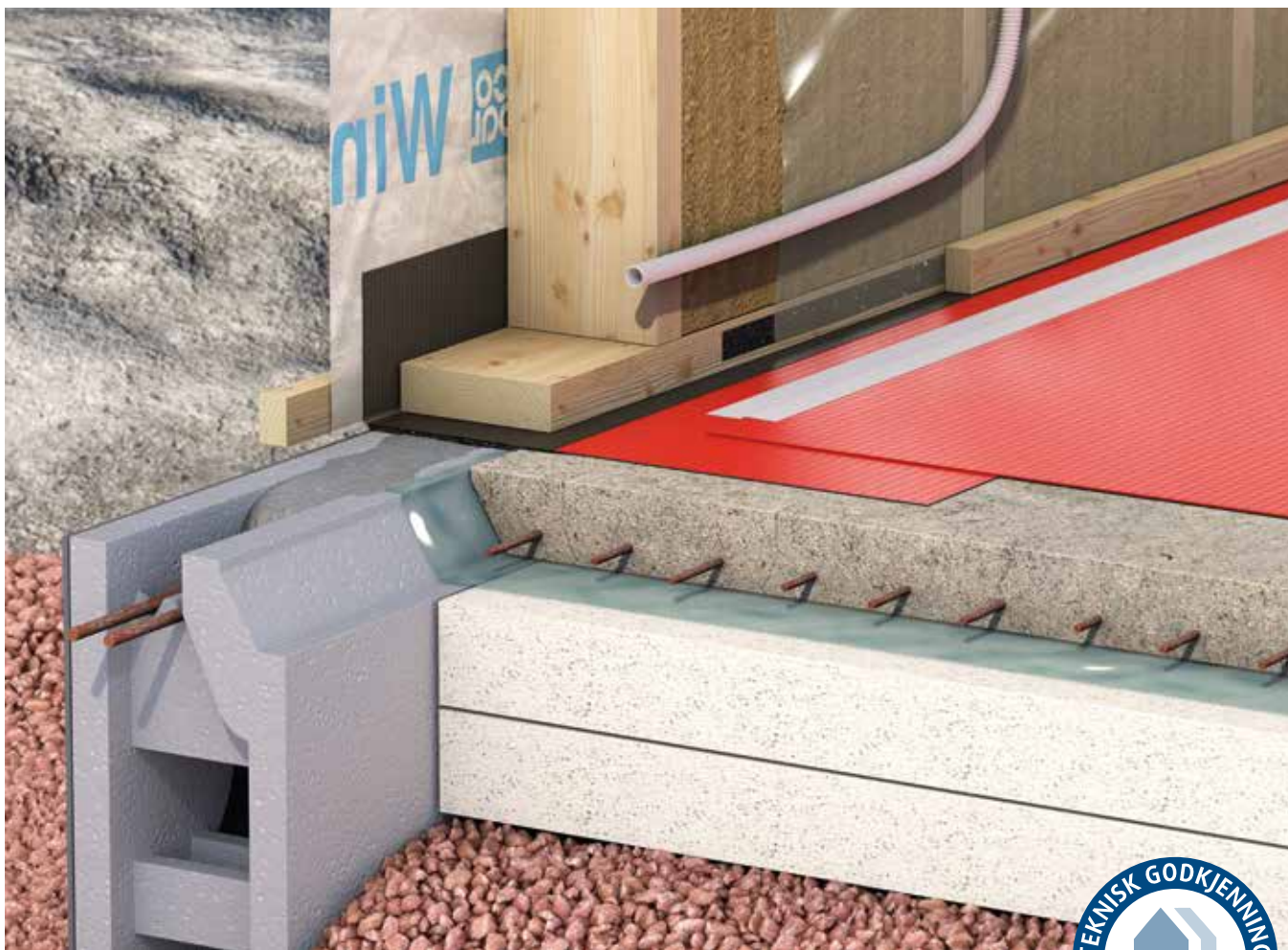
BMI Svillemembran med radonflik, her vist koblet sammen med radonsperre i bruksgruppe C.
