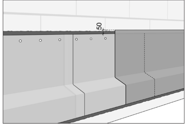
Seuraavat bitumikermi kerrokset.
