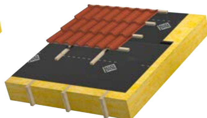
Luftet konstruksjon med AeroDek ståltakplater med forenklet løsning på diffusjonsåpent undertak lagt rett på taksperrene.
