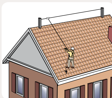
CON PUNTI DI DEVIAZIONE. Gancio sottotegola A utilizzato come deviatore di caduta
