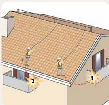
RISCHIO DI CADUTA PER: 1) effetto pendolo 2) tirante d'aria insufficiente
